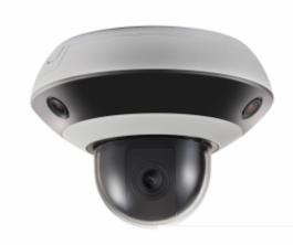
Разрешение 2Мп Матрица 1/2.8" Progressive Scan CMOS 3 x 2 мм @ F2.0 Аппаратный WDR 120дБ Высокая чувствительность 0.05к Слот для microSD до 256Гб Питание DC12B/ PoE+
